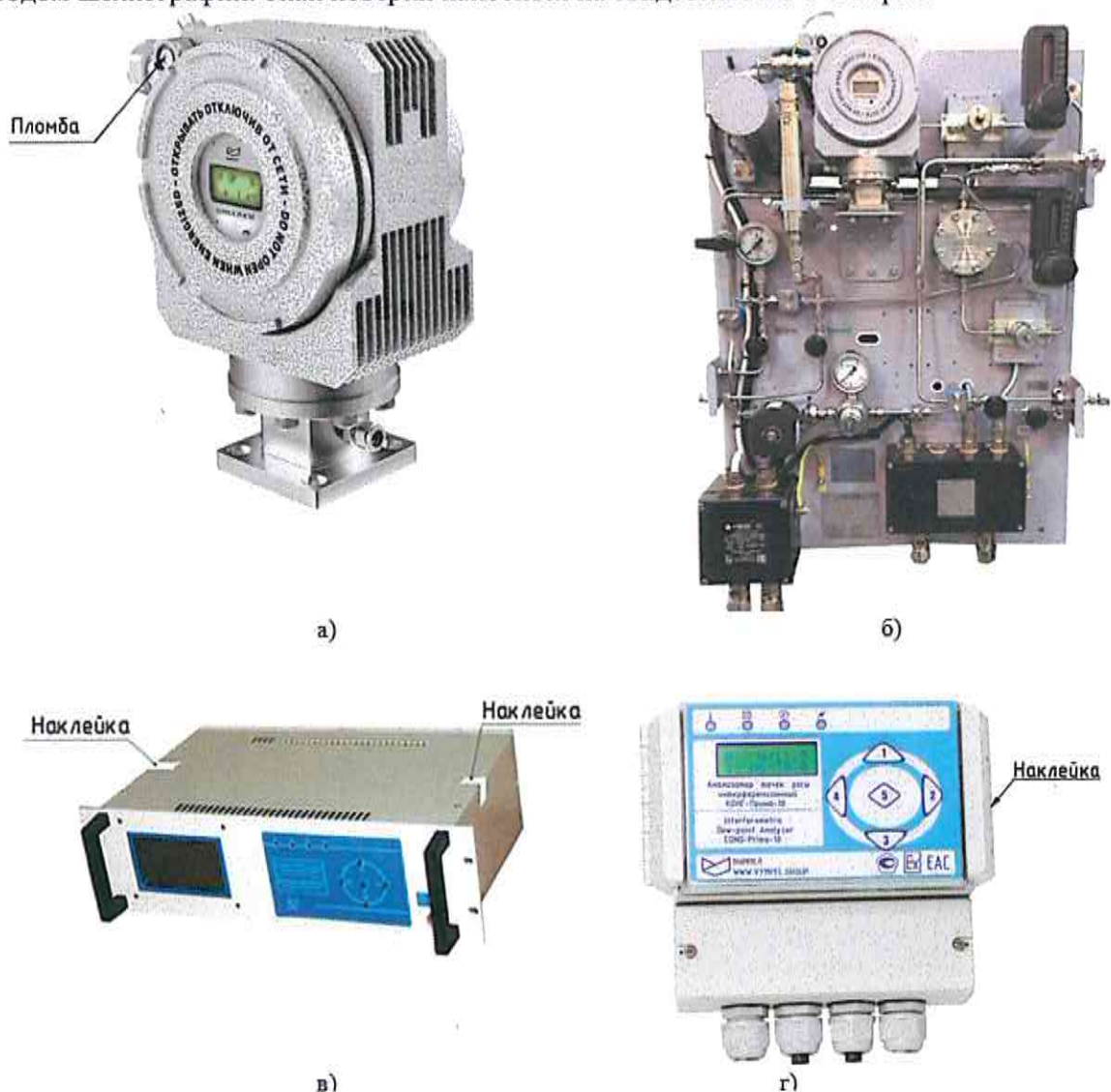
Рисунок 1 - Фотографии общего вида основных составных частей анализатора и схема пломбировки от несанкционированного доступа а) ПТР исполнение КРАУ2.848.004-01(-02); б) ПТР, установленный на систему подготовки газа КРАУ2.848.012; в) центральный управляющий блок КРАУ3.035.001-03; г) интерфейсный блок КРАУ3.622.002-01
